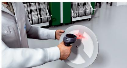
Мобильная идентификация монтажных материалов. Быстрая идентификация кода, независимо от углового положения, посредством встроенной матричной камеры.
