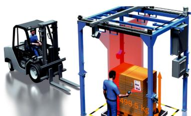
Для стационарных систем измерения объема часто требуется мобильное считывание кода для идентификации товара – экономически решено посредством подключения AUX.
